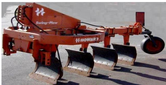
4-расм. “Howard Swing-Plow SPY” фирмасида ишлаб чиқарилган бурилма плуг
