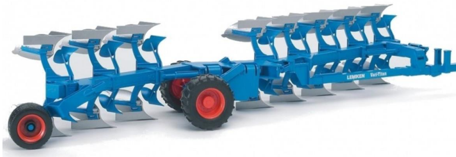
1-расм. Германиянинг “Lemken” фирмасида ишлаб чиқарилган айланма плуг
