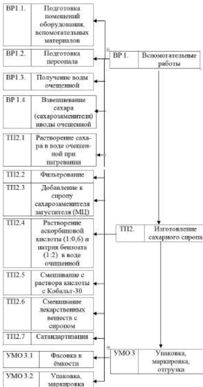
Рис.1. Технологическая схема производства сиропа Кобальт-30
